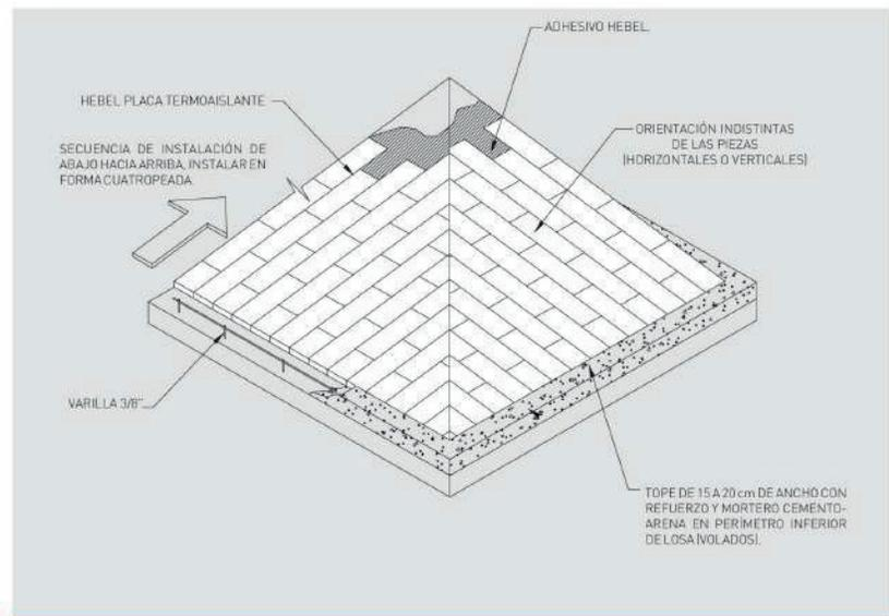
Fig. 1: Hebel Placa termoaislante en losa inclinada.
