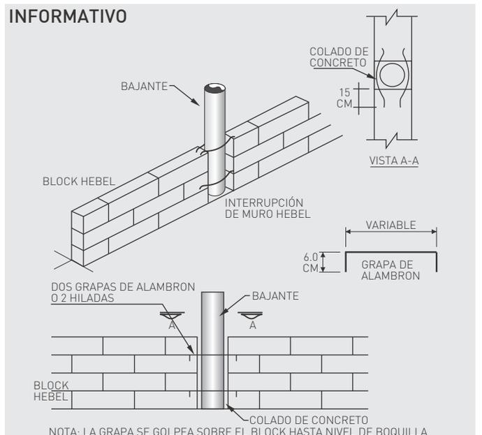
Fig. 14: Detalle de bajante sanitario o pluvial.
