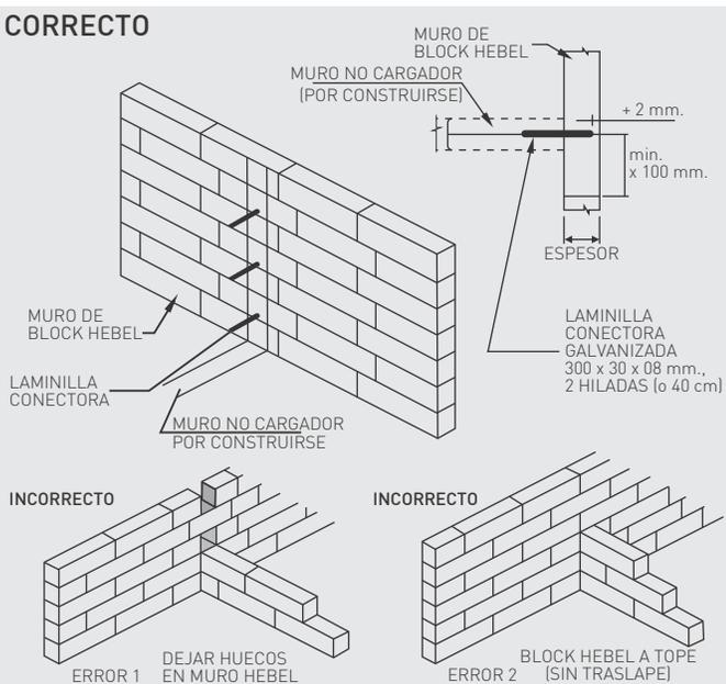
Fig. 13: Unión de muros cargadores a no cargadores.
