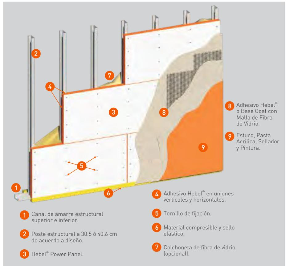
Fig. 22 Muro Exterior
