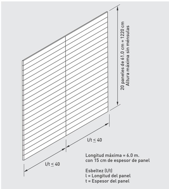
Fig. 3: Arreglo horizontal de paneles Hebel para muro.
