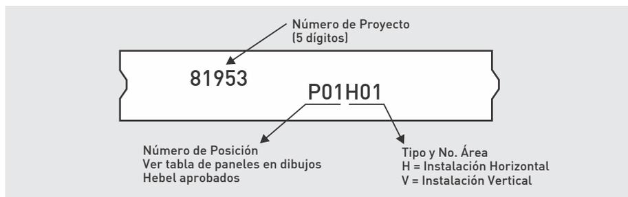
Fig. 5: Identificación de Panel Hebel para muro.
