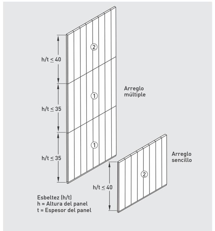
Fig. 4: Arreglo vertical de paneles Hebel para muro.
