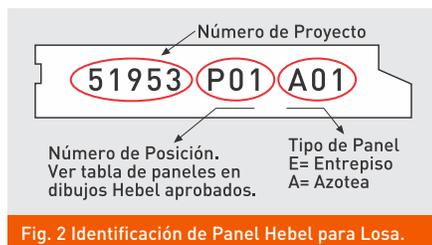
Fig. 2 Identificación de Panel Hebel para Losa.
