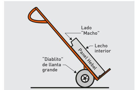
Fig. 6: Posición del panel durante el transporte.
