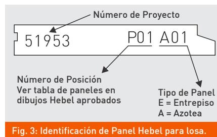
Fig. 3: Identificación de Panel Hebel para losa.
