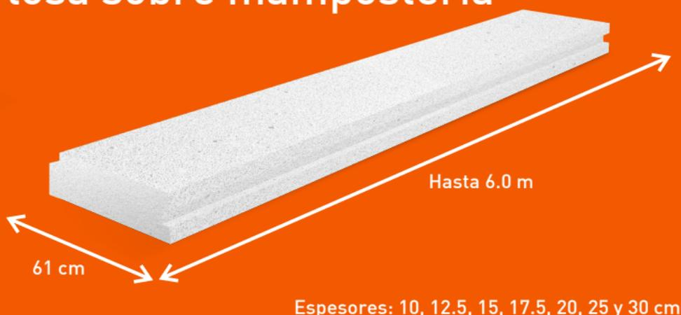
**Descripción:** Son elementos reforzados para la construcción de losas de entrepisos y azotea que trabajan simplemente apoyados sobre mampostería (Hebel o tradicional), estructura de acero, concreto o madera sin necesidad de colocar apuntalamiento ni cimbras. Se diseñan de acuerdo a los requerimientos de claro y carga.
