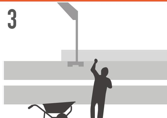
Primer panel se desplanta sobre mortero cemento - arena 1:4 para nivelar.
